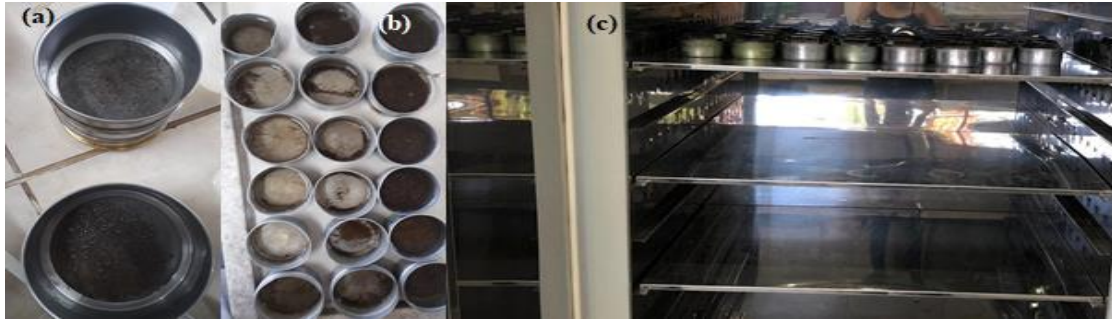
Figura 9. Massa de solo retida nas peneiras (a); massa de solo separada em latas para estufa; latas na estufa (c)
