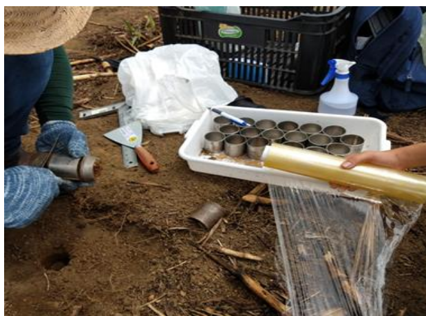
Figura 3. Coleta e embalagem em plástico filme dos anéis para densidade do solo
