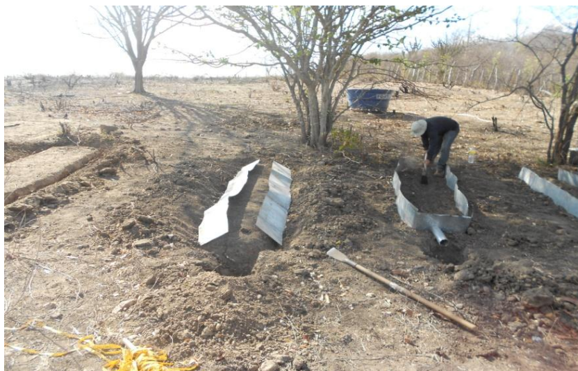
Figura 18. Instalação dos sulcos de erosão na área experimental sulcos na bacia hidrográfica do riacho Exu, Serra Talhada – PE
