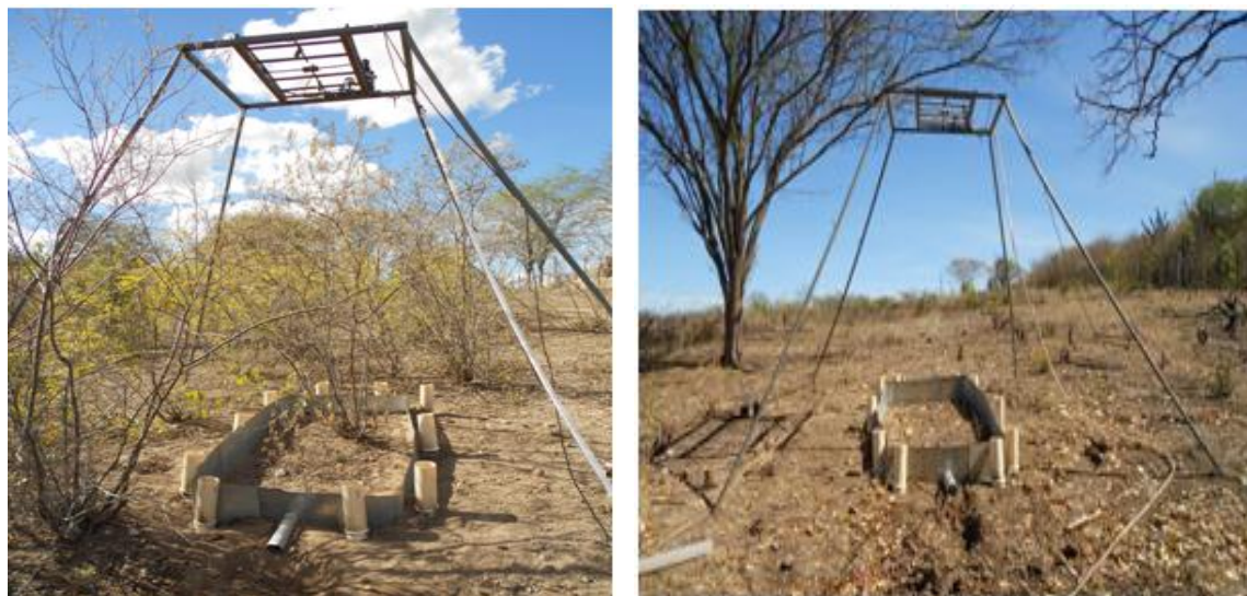
Figura 15. Simulador de chuva utilizado para determinar as taxas de erosão em entressulcos na bacia hidrográfica do riacho Exu, Serra Talhada –PE.
