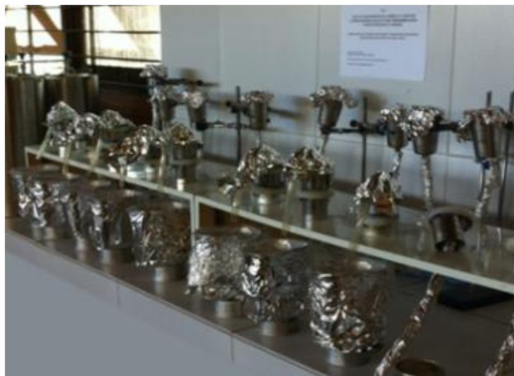
Figura 9 - Estrutura com proteção em papel alumínio utilizada para lixiviação de possíveis agentes de coesão quando utilizado o ácido oxalato de amônio (reagente de Tamen)
