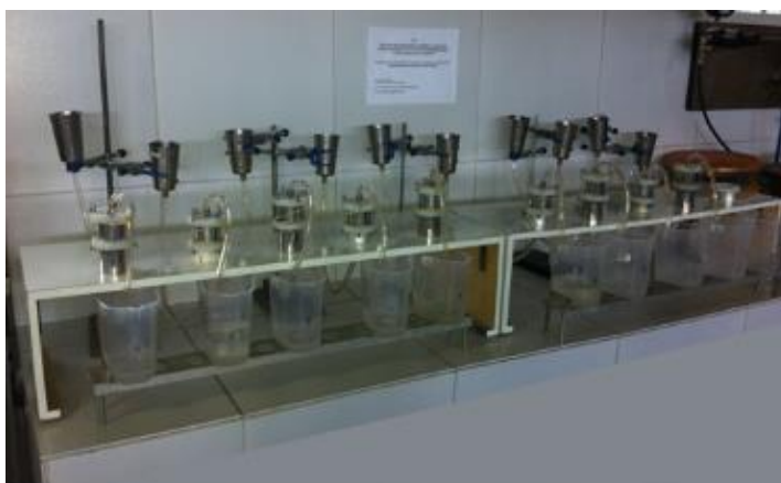
Figura 8 - Estrutura utilizada para lixiviação de possíveis agentes de coesão
