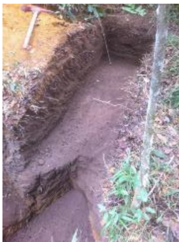
Figura 6 - Corte do perfil após retirado o horizonte A para retirada de amostras indeformadas em anéis
