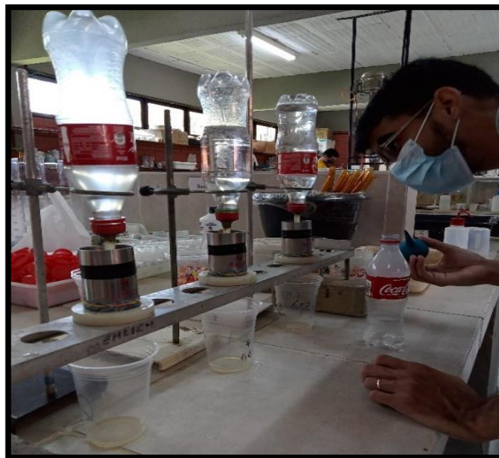
Figura 7. Determinação da condutividade hidráulica saturada ( K_{sat} )
