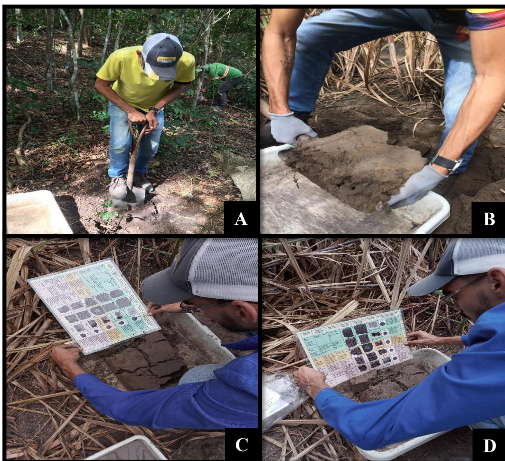
Figura 4. Coleta do bloco (A); bloco na bandeja (B); medição das camadas com auxílio da régua da cartilha VESS (C); analisando o bloco e conferindo a nota de acordo com a cartilha VESS (D)
