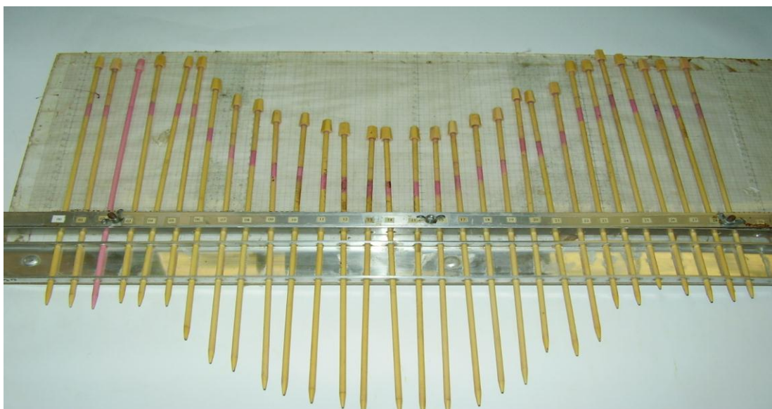
Figura 2. Perfilômetro utilizado para obtenção das seções geométricas dos sulcos de erosão.
