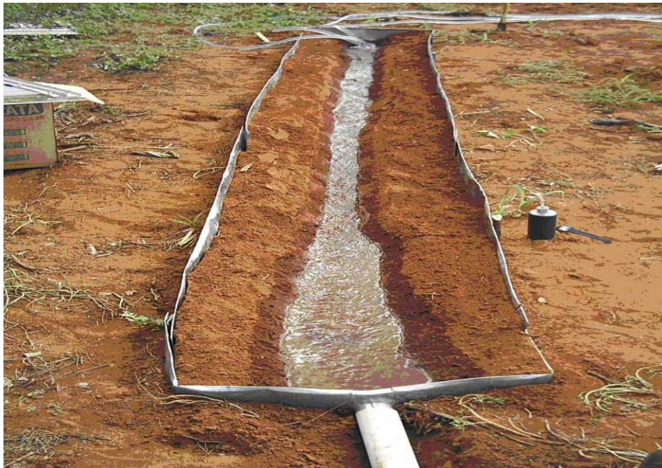
Figura 2. Aspecto do sulco pré-formado em um CAMBISSOLO com textura franco arenosa sob aplicação de 60 \text{ L m}^{-1} .
