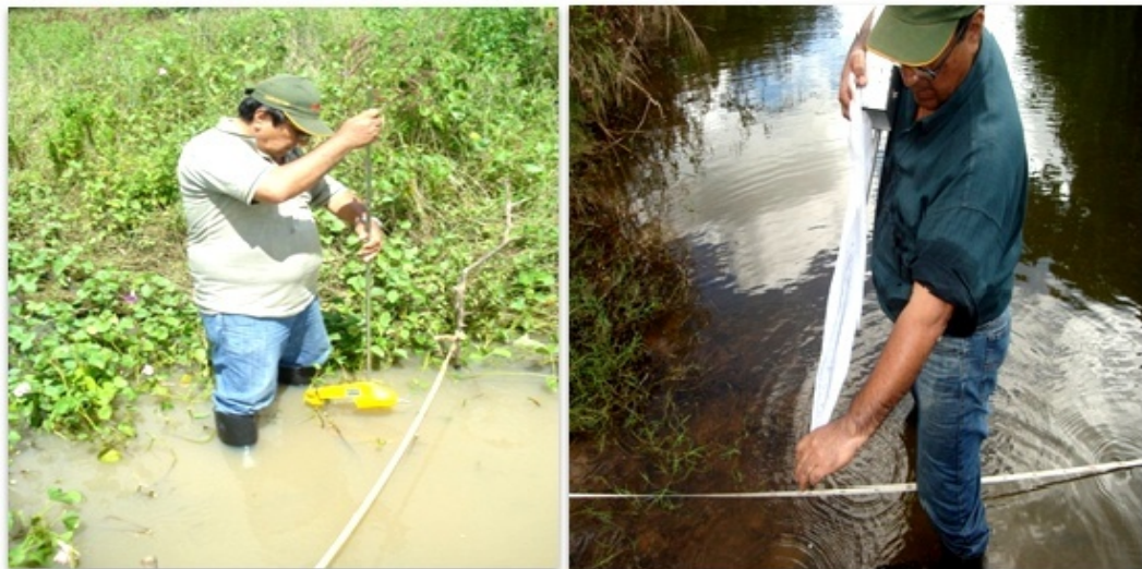
Figura 22. Amostragem de sedimento suspenso, com o amostrador (DH-48) e amostragem de sedimento de fundo, com o amostrador USBLH-84.
