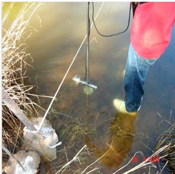
Figura 11. Micromolinete fluviométrico apropriado para pequenas vazões a vau no leito do riacho Jacu.
