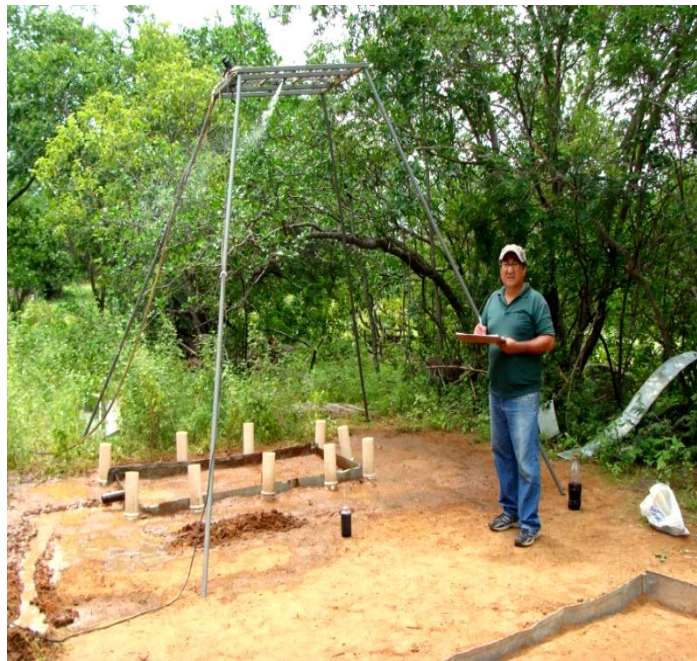
Figura 15. Simulador de chuva para com intensidade planejada em solo descoberto.
