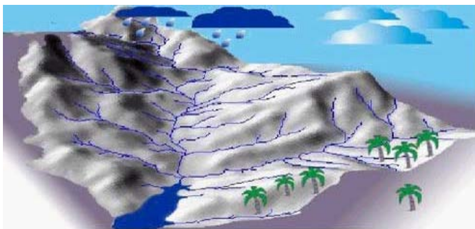
Figura 1. Ilustração de uma bacia hidrográfica mostrando os divisores de água, as sub-bacias e a drenagem principal (Santana, 2003).
