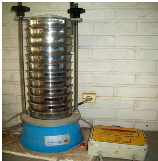
Figura 22. Agitador eletromagnético utilizado na classificação dos sedimentos de fundo da bacia hidrográfica do riacho Jacu.
