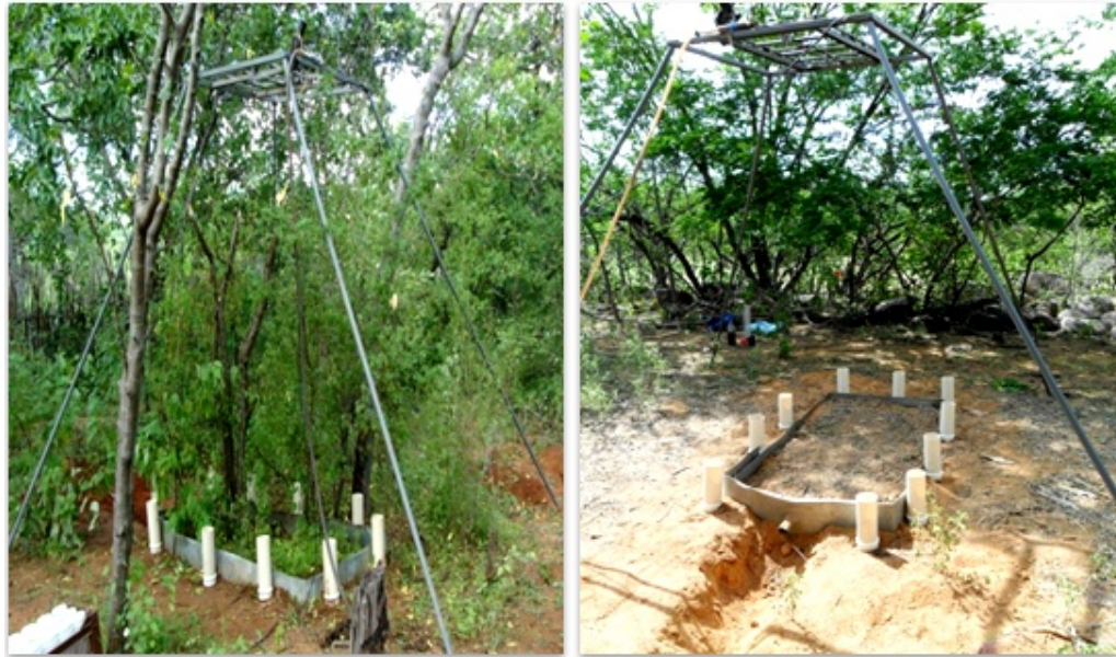
Figura 14. Simulador de chuva com intensidade planejada em solo com catinga semi-arbustiva e simulador de chuva com intensidade planejada em solo coberto por serrapilheira.
