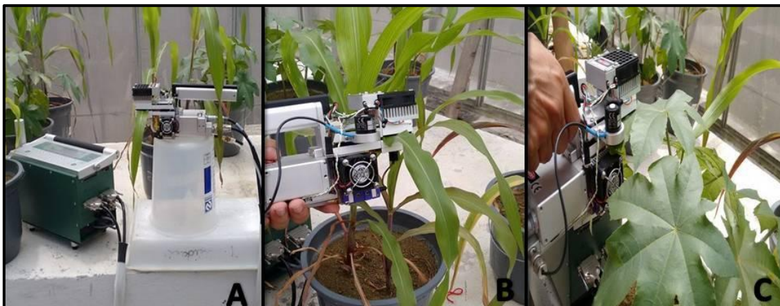
Figura 2. Medição dos parâmetros fisiológicos: (A) analisador portátil de gases IRGA, (B) medição na cultura do milho e (C) medição na cultura da mamona.
